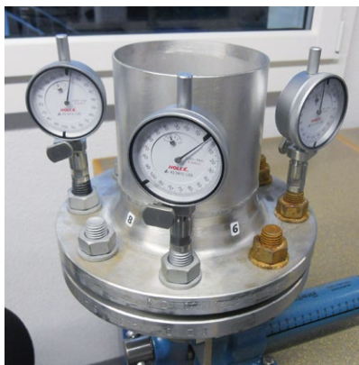
Anzugsverhalten bei Einsatz von verschiedenen und auch defekten Schrauben
