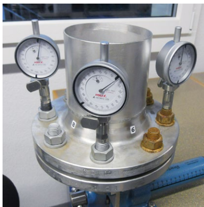
Comportement de vissage lors de l'utilisation de différentes vis y compris des vis défectueuses
