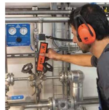
Inspection manuelle avec appareil de mesure à ultrasons.
