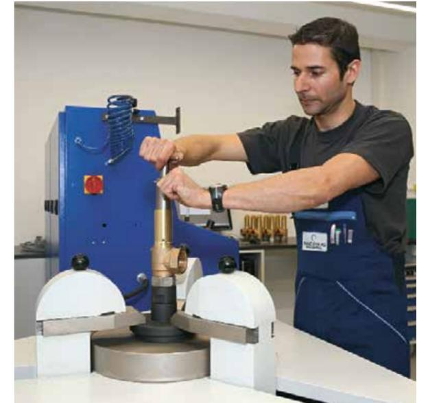
Réglage et plombage des soupapes de sécurités conformément à l'ASIT
