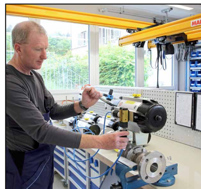
Montage d'une motorisation pneumatique
