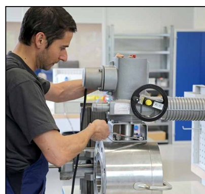
Montage d'une motorisation électrique
