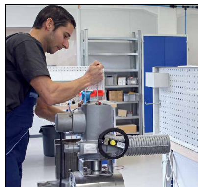
Test et ajustage d'une motorisation électrique
