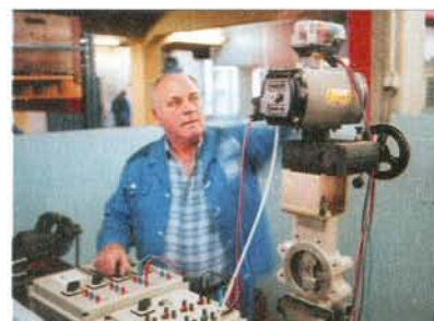
Essais sur une vanne d'arrêt à actionnement pneumatique
