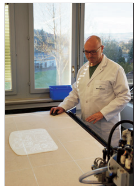
Das Schnittmuster wird per Laserstrahl abgetastet und das Messer exakt geführt.
